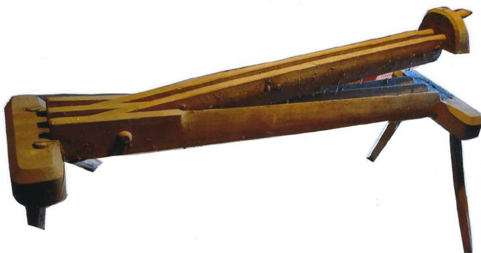
Stängel vom Hant Knitzsche wurden mit der Knitzsche gebrochen und danach Seiler gedreht.
